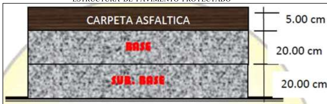
IMAGEN N°4.1 ESTRUCTURA DE PAVIMENTO PROYECTADO
