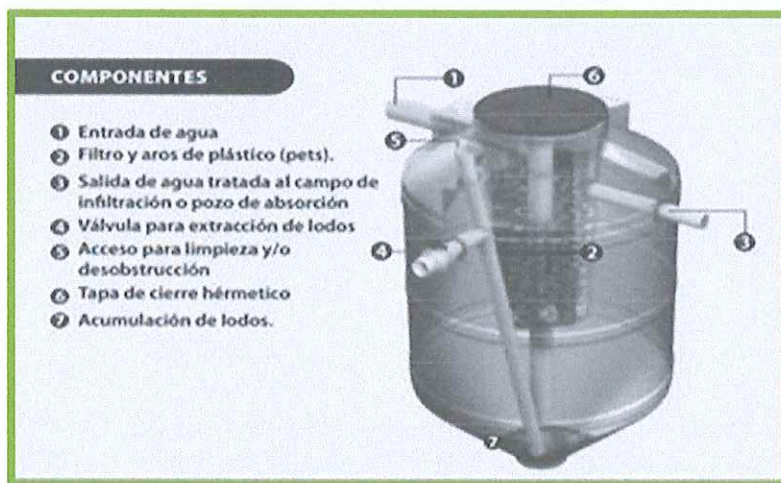
IMAGEN N° 09: Componentes del biodigestor.
