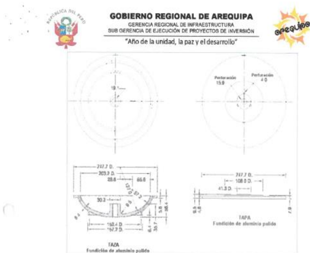
Figura 1. Recipiente extractor (método de ensayo A)
