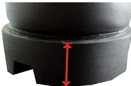
FIGURA N° 8: Altura del taco: \geq 30 mm.
