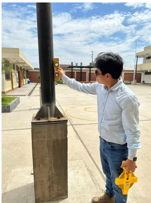
Fotografías de la verificación de alineación de columnas Insitu
