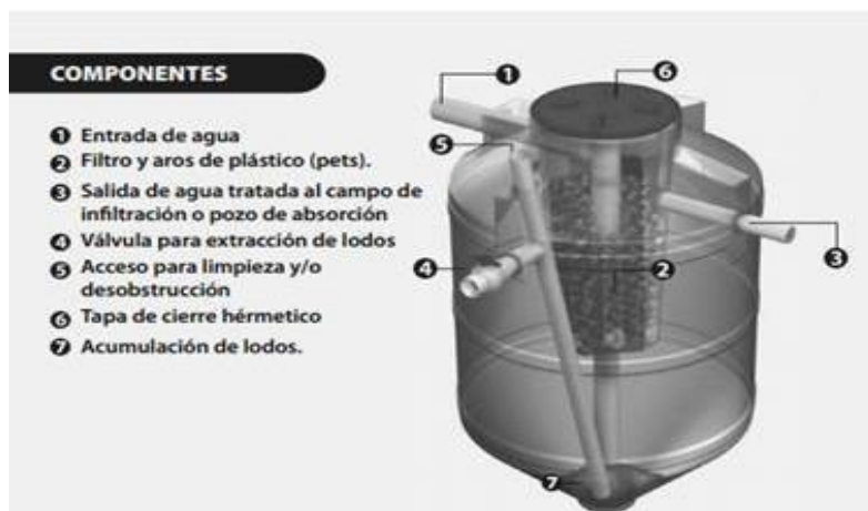
IMAGEN N° 57: COMPONENTES DEL BIODIGESTOR
