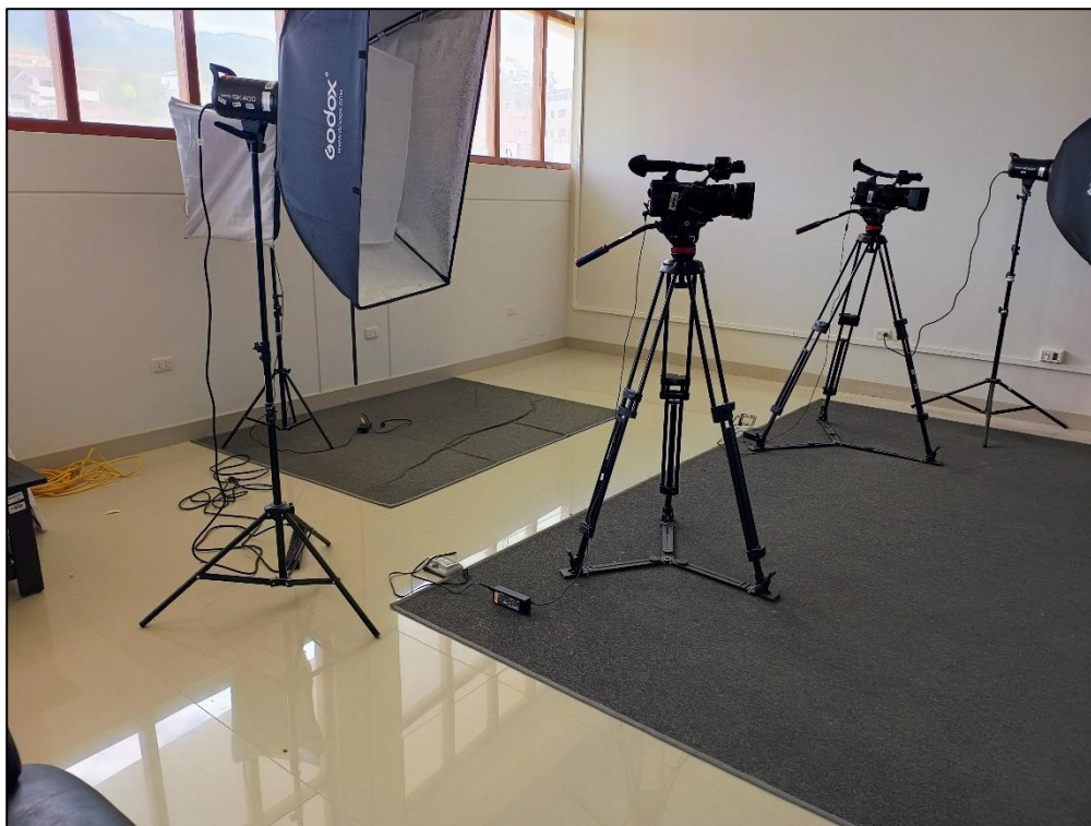
Imagen N°3: Vista del set de televisión, donde sus cerramientos (paredes, cielo raso y ventanas) no cuentan con un aislamiento acústico.
