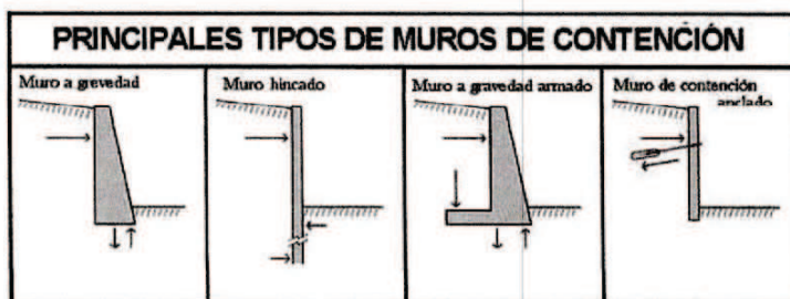
FIGURA 7.3 Medidas de control mediante Muros de Contención
