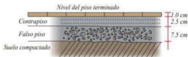
Figura 5. Imagen referencial de detalle del contra piso
