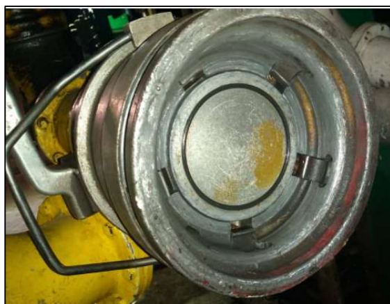
Figura 4: Acoplador API Bottom-loading
