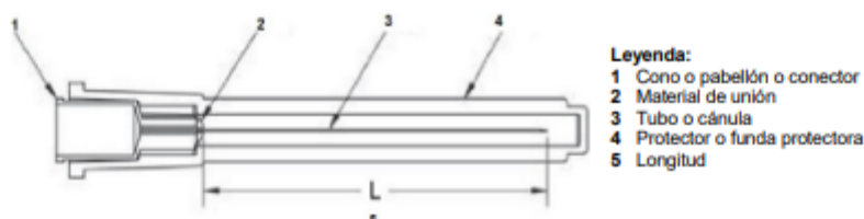
Figura referencial: Representación esquemática de una aguja hipodérmica y protector típico, para un solo uso
