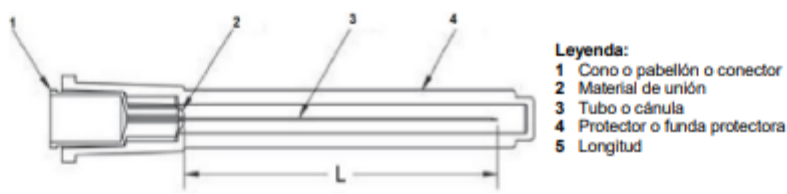
Figura referencial: Representación esquemática de una aguja hipodérmica y protector típico, para un solo uso
