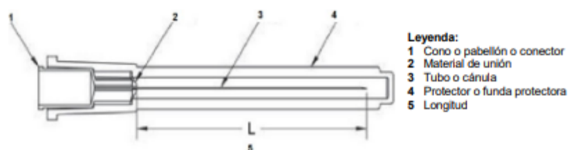
Figura referencial N° 4: Representación esquemática de una aguja hipodérmica y protector típico, para un solo uso
