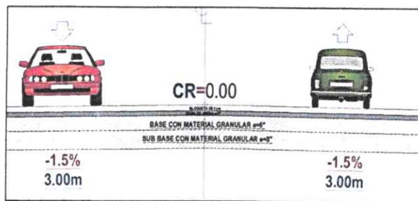
DETALLE DE PAVIMENTO ARTICULADO – ADOQUIN DE C° DE 20X10X6CM.
