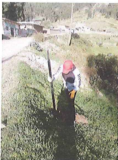
Excavaciones y muestreo en la Calicata C-05 en la Progresiva 02+460
