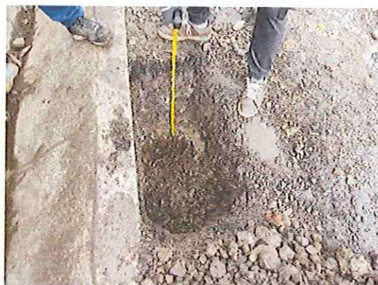
Excavaciones y mediciones de los espesores de la estructura del pavimento existente en la progresiva 04+160
