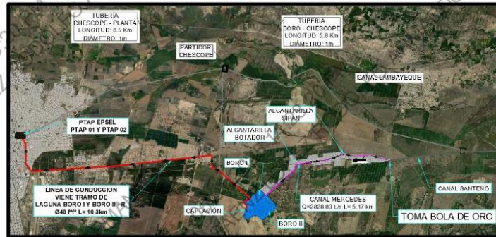
ILUSTRACIÓN N° 19: ESQUEMA DE ABASTECIMIENTO DE FUENTE SUPERFICIAL PARA AGUA POTABLE
