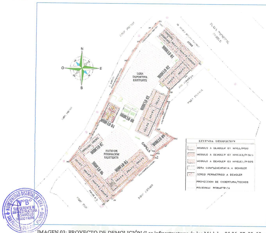
IMAGEN 03: PROYECTO DE DEMOLICIÓN (Las infraestructuras de los Módulos 05,06, 07, 08, 09 y parcialmente 04 han sido demolidos)
