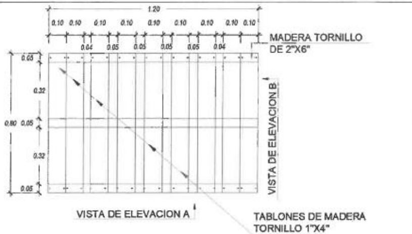
Figura 2: Detalle en planta del reverso de la estructura.
