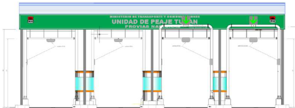
Elevación frontal de pódium para RFID en la plaza de peaje (referencial)
