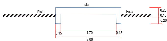
Sección típica de la isla
