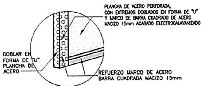
DETALLE B DOBLEZ ESC: 1/5
