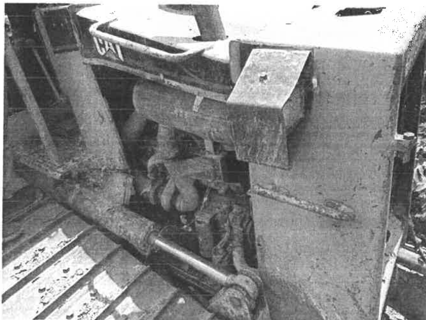
8. CAPOT DE MOTOR CON ABOLLADURAS (REQUIERE REPARACION)
