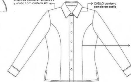
DELANTERO: Corte unido a 8mm (R) con remalle y puntada de seguridad
