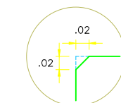
DETALLE DE OCHAVO EN ARISTAS ESC. 1:10
