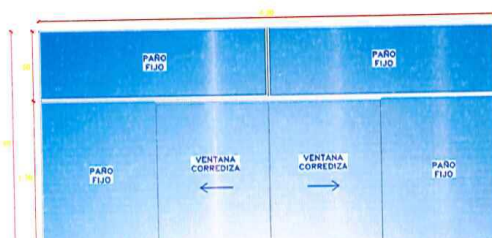
VENTANA V 10 escala: 1/25 1 unidades VIDRIO TEMPLADO 6 mm.
