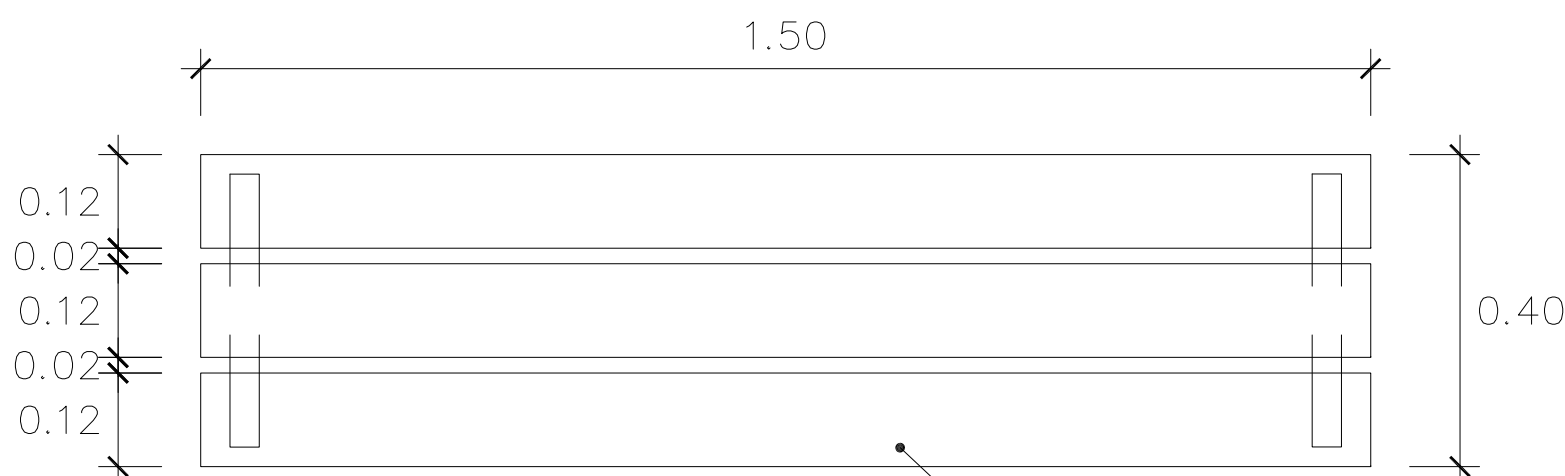
PLANTA BANCO DE MADERA \phi=1\frac{1}{2}" ESCALA: 1/10
