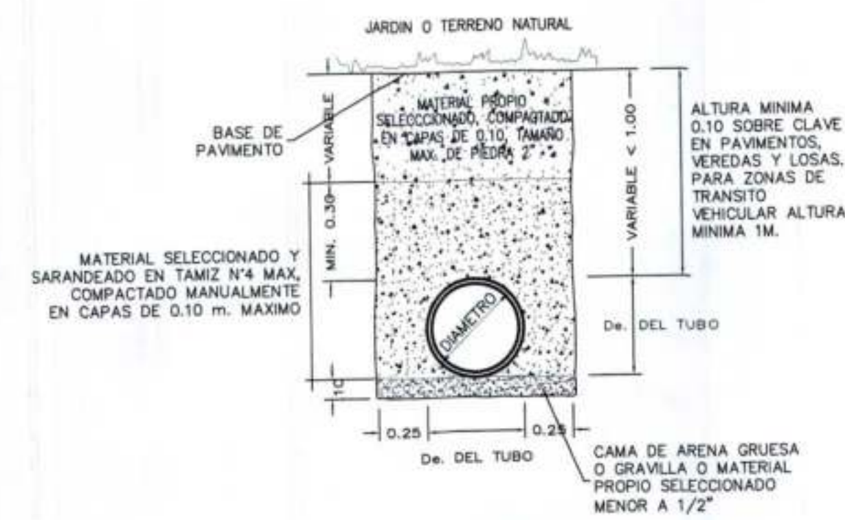
DETALLE DE ZANJA PARA TUBERIA DE DESAGUE EN ZONA DE TRAFICO PEATONAL (S/E)
