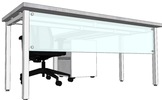
Imagen: Estructura de Escritorio con niveladores + mandil en vidrio con lamina de seguridad acabado Frost fijado con pines de acero inoxidable.
