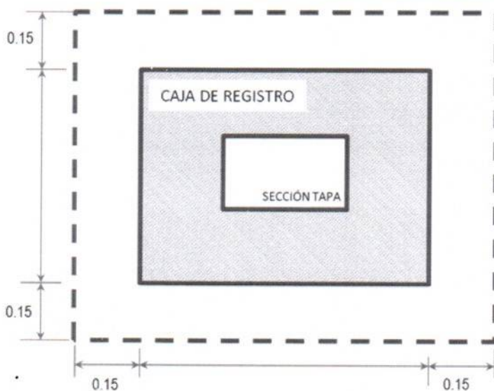
Dimensión de ancho de caja de registro para Medidor de ½"
