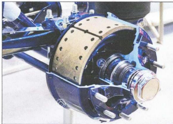
Fotografía 6: Freno de tambor y zapata
