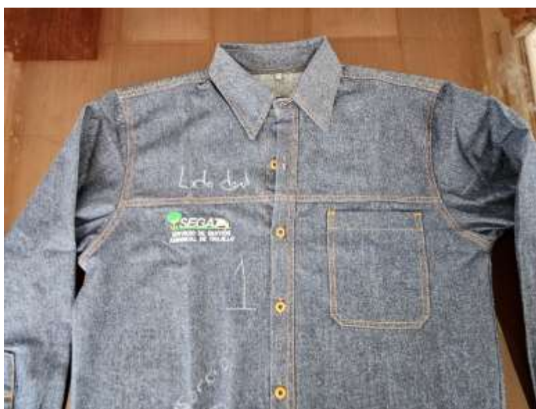
Canesú normal unido con parte delantera con maquina remalladora puntada 514 GG 3/16 y asentado con maquina recta de 2 agujas
