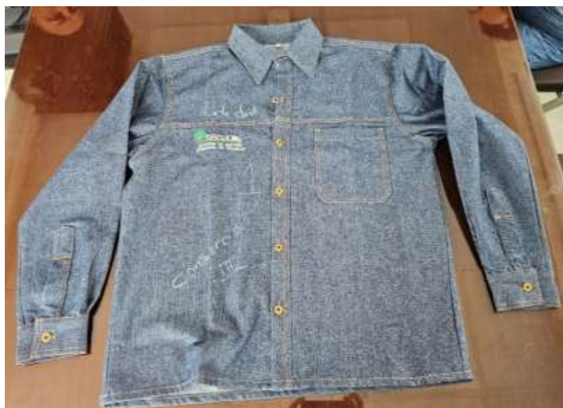
Canesú normal unido con parte delantera con maquina remalladora puntada 514 GG 3/16 y asentado con maquina recta de 2 agujas
