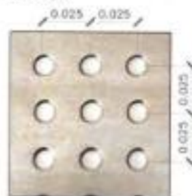
DETALLE E PLANCHA DE ACERO PERFORADA ESC: 1/2
