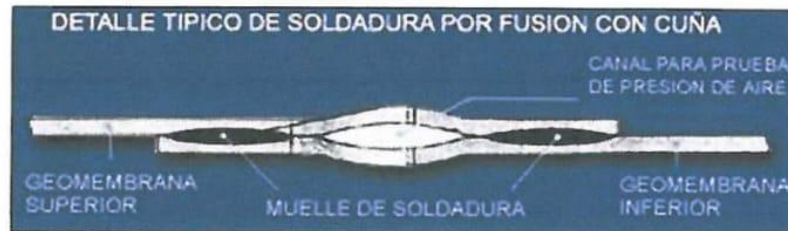
2. Soldadura termofusión.
