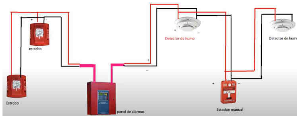
Figura 16. Imagen referencial del funcionamiento del sistema DACI
