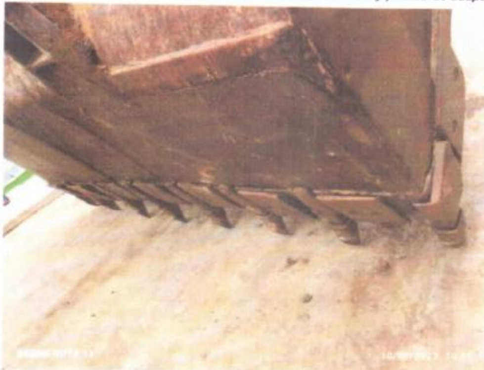
4.- existe desgaste excesivo del lampón, taloneras, cuchillas y pernos de adapter
