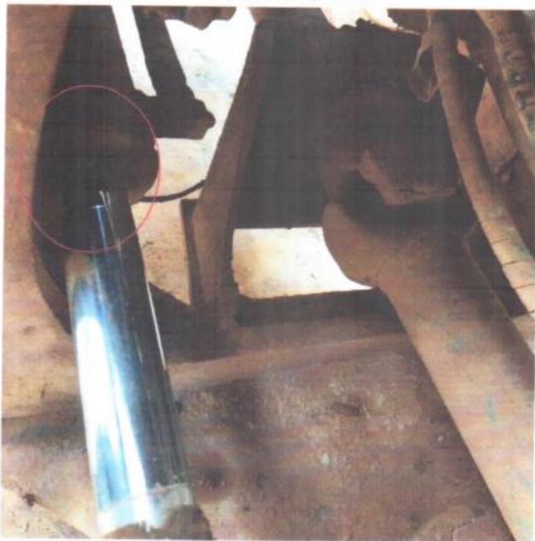
8.- Fuga de aceite por cilindros hidráulicos de dirección.
