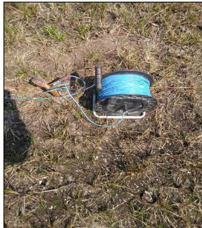
Cableado para medir la resistividad del terreno
