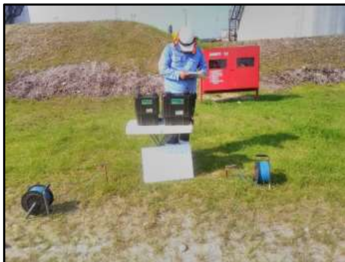
Fotografía N° 5: Ejecución de Sondaje Eléctrico Vertical (SEV)
