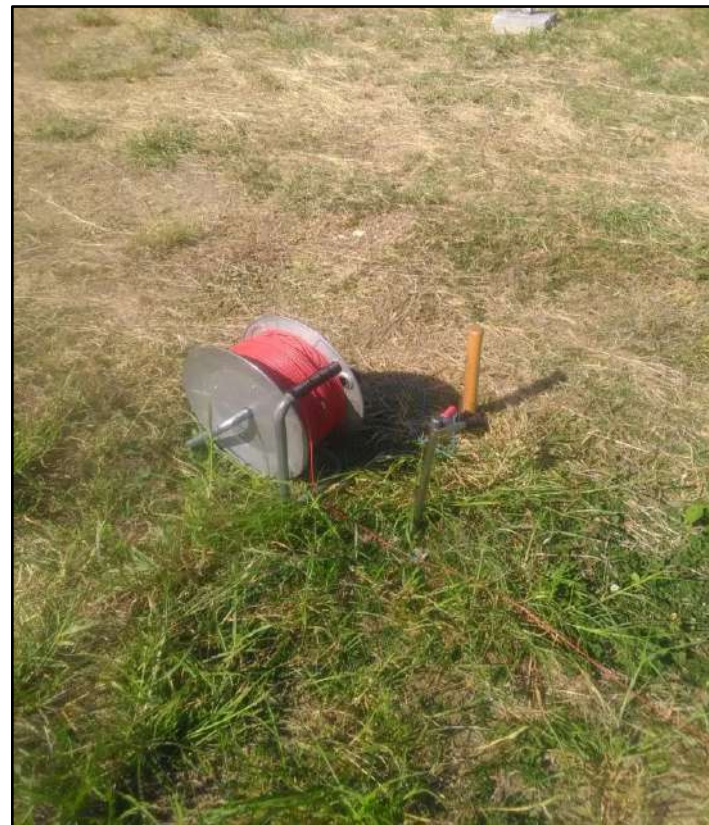
Cableado para medir la resistividad del terreno
