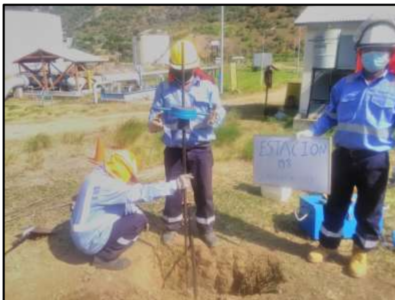
Fotografía N° 1: Ensayo DPL.
