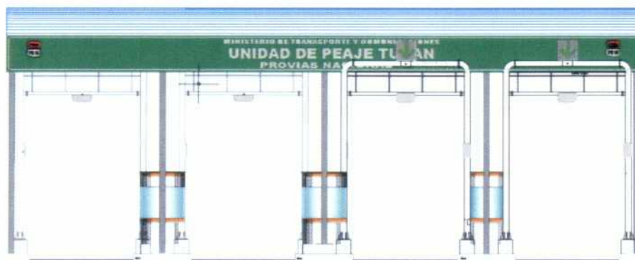
Elevación frontal de pòrtico para RFID en la plaza de peaje (referencial)
