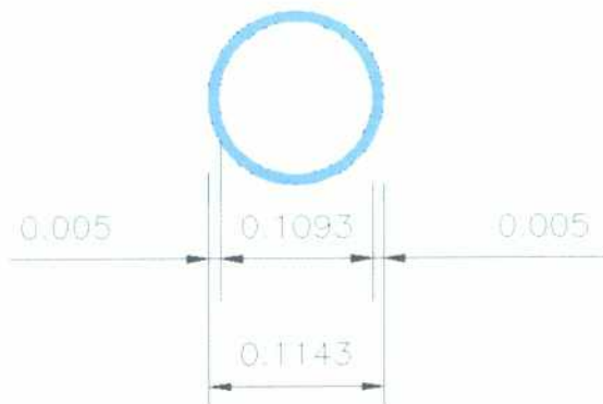
Sección de viga principal de pórtico.
