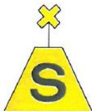
Figura 3. Pictograma definido por Hidronav para marcar las boyas que indican la presencia de cables, oleoductos y conducciones submarinas
