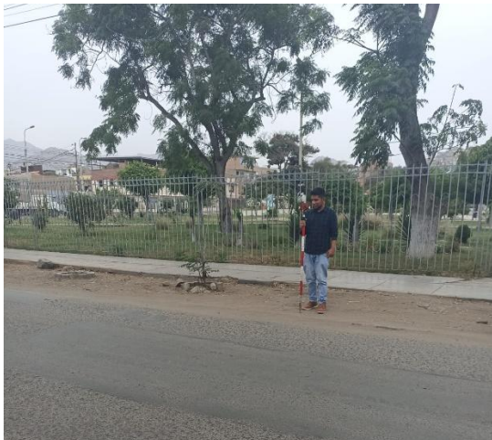
IMAGEN 7: Levantamiento del relieve de vías existentes (pistas).
