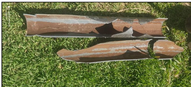
Imagen 7. Tramo captación "Las Lucmas" – Reservorio existente, tubería en malas condiciones. Fuente: Elaboración propia.
