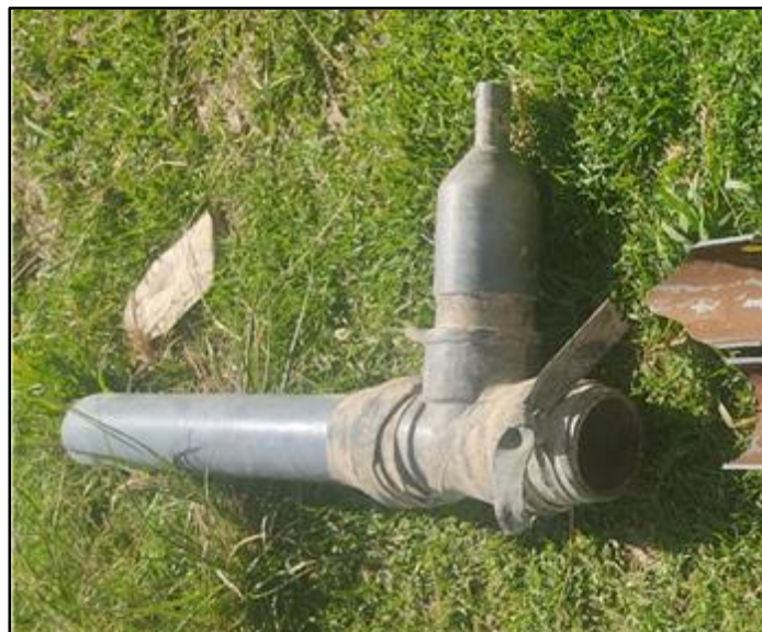
Imagen 9. Tubería de red de distribución en mal estado.
