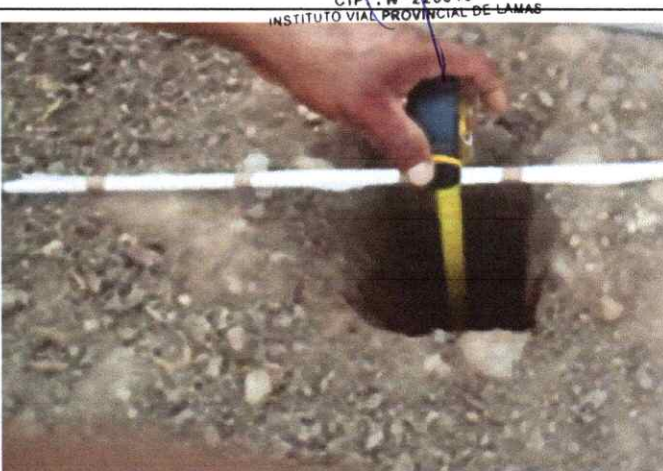
Foto 12: Espesor de la plataforma 0.07 mts. En el Km. 2+750
