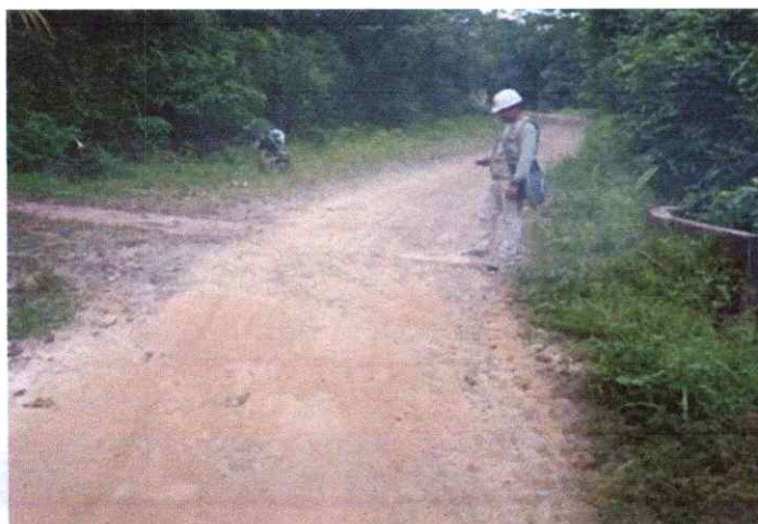
Foto 05: Hito Kilometrico 03+000 , Se observa que no existe el Hito Kilometrico.
