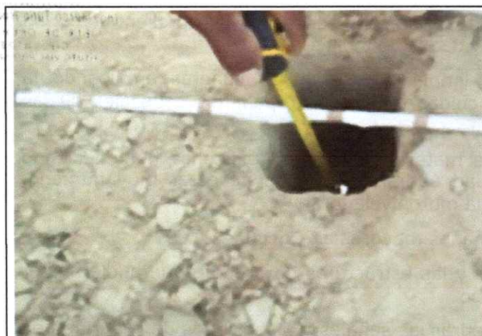
Foto 11: Espesor de la plataforma 0.07 mts. En el Km. 2+500
