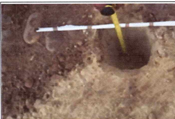
Foto 17: Espesor de la plataforma 0.05 mts. En el Km. 4+000
