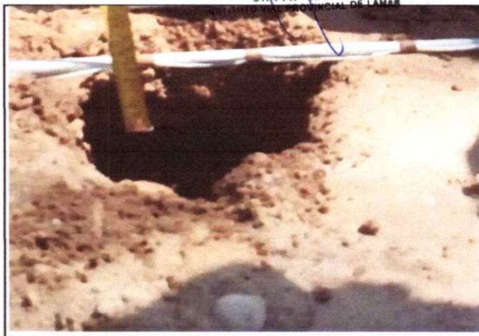
Foto 06: Espesor de la plataforma 0.04 mts. En el Km. 1+250
