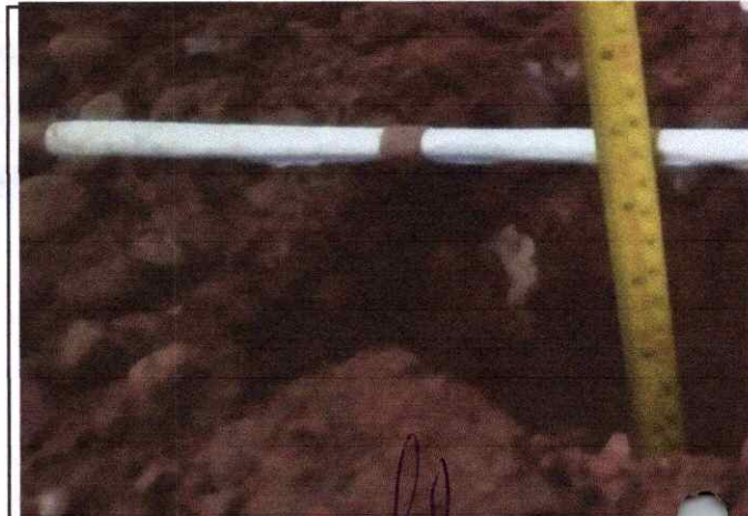
Foto 16: Espesor de la plataforma 0.04 mts. En el Km. 3+750
