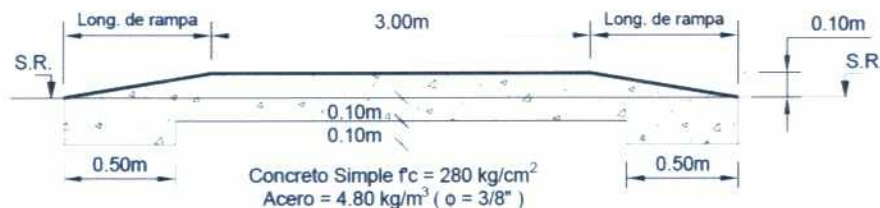
Sección de resalto del concreto
