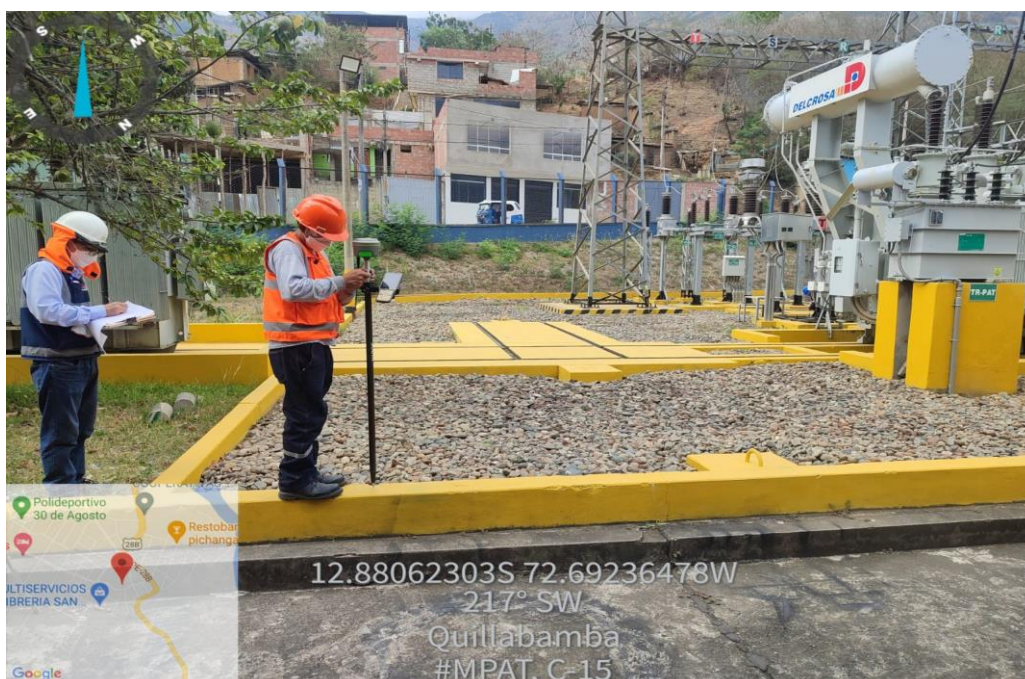
Figura 3. Levantamiento Topográfico método RTK S.E. Urpipata.
