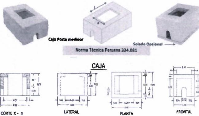
Las cajas se deben ubicar en las veredas, cuidando que comprometa solo un paño de ésta, en las dimensiones consideradas en los metrados. En caso de no existir veredas, la caja se ubicará en una losa de concreto de  $f'c=175 \text{ Kg/cm}^2$  con un área de vereda  $0.70 \times 0.50 \text{ m}$ , y espesor de 15 cm, sobre una base debidamente compactada.
