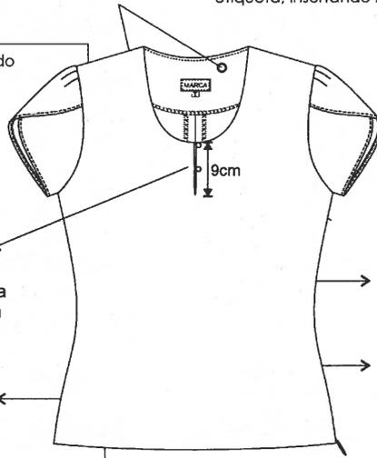
DELANTERO: 03 PIEZAS Corte unido a 8mm(I.R) con remalle y puntada de seguridad
