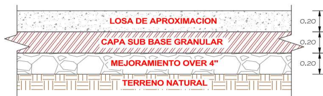
Imagen 2: Detalle de losa de aproximación.
