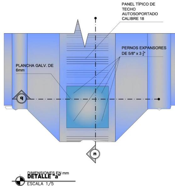
Una vez anclada la cobertura a la viga principal, se fijarán en las juntas del arco de cobertura de Galvanizado prepintado, es decir se realizará el sellado del segundo paso con la finalidad que en las secciones se asegure el 100 % de la hermeticidad con maquinaria selladora eléctrica.
