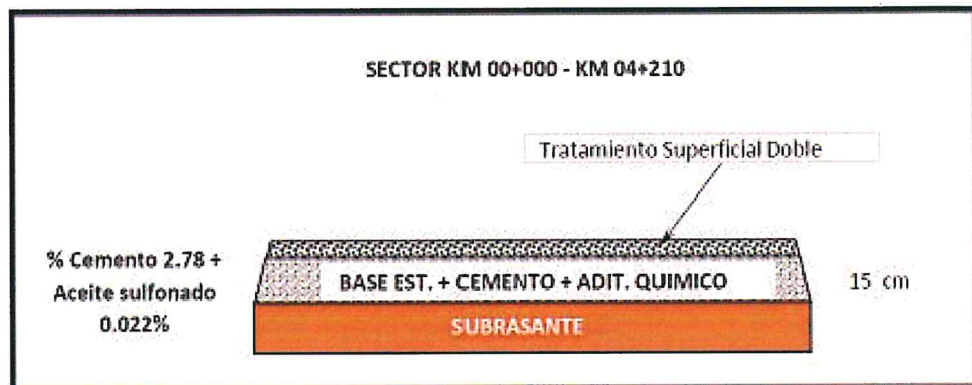
Figura 3. Estructura de Pavimento
