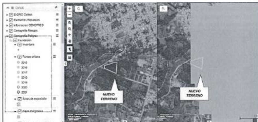
Figura N° 13: Sistema SIGRID / Cartografía de Peligros/ Inundación: Puntos críticos, Inventario, Áreas de exposición Fajas Marginales y Niveles de Susceptibilidad Alta por Inundación (fluvial/pluvial) en el nuevo terreno Fuente: http://sigrid.cenepred.gob.pe/sigrid/
