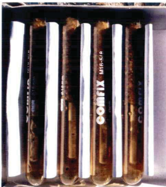
Detalle de pegamento epóxico M16- 5/8
