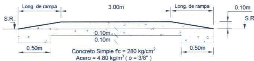
Sección de resalto del concreto
