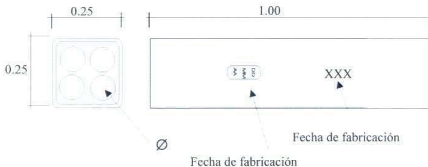
Detalles del ducto de 4 vías
