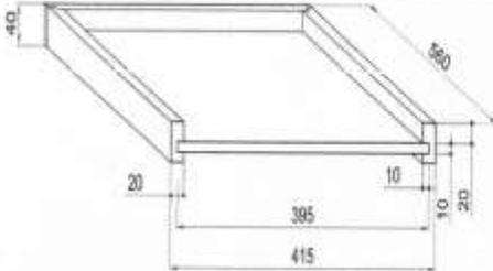
Tapa: Compuesto por una lámina de madera de 8 mm de espesor y de 56 cm x 47 cm, unida a cuatro regletas como marco, dos para el lado largo y dos para el corto. Recubierto por una lámina de aluminio o calamina galvanizada de 2 mm de espesor y pegada por el lado 14 mm.
