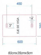
PLANCHA METALICA APOYO MOVIL
