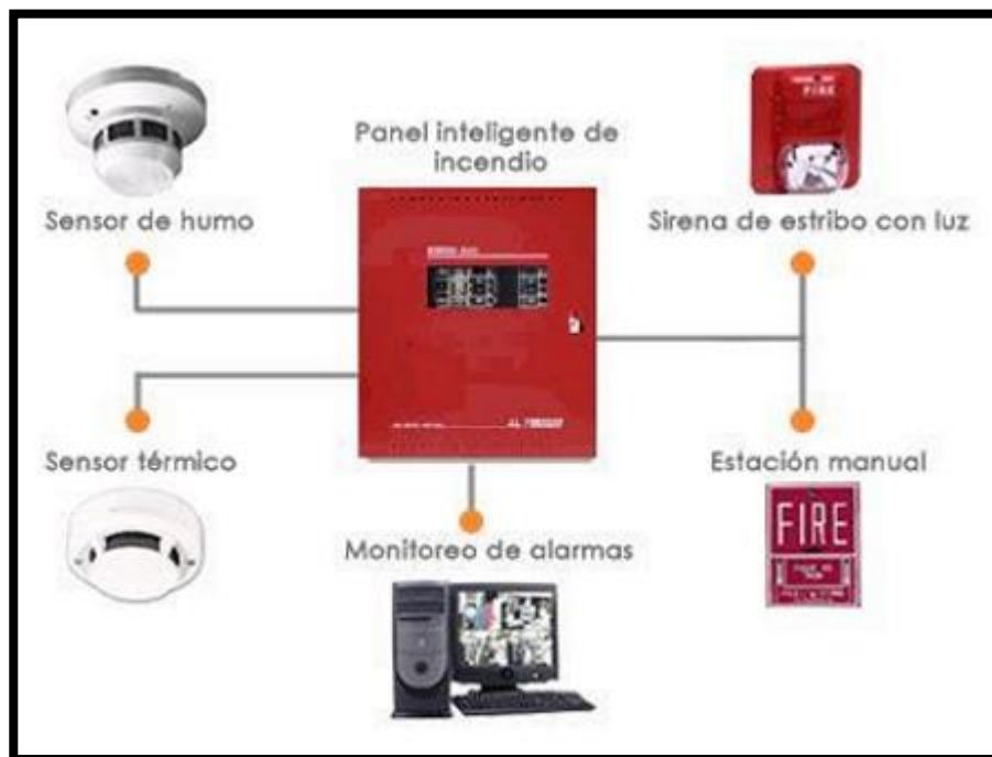
Sistema interconectado de alarmas contra incendio con distintos implementos
